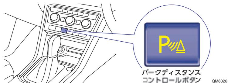
障害物に近づくとピッピッピッという警告音が鳴り、インフォテイメントシステムのディスプレイに黄色い表示がおおよその距離と角度で表示されます。
