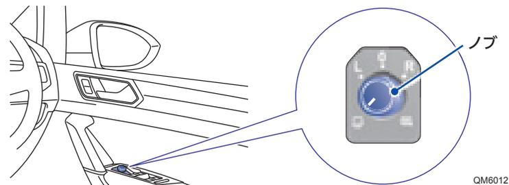
車両をリモコンキー、またはスマートエントリー&スタートシステム“Keyless Access”で施錠することでも自動的に格納されます（イグニッションスイッチを“ON”にすると復帰）。この機能はインフォテインメントシステムで設定を切り替えることができます。
