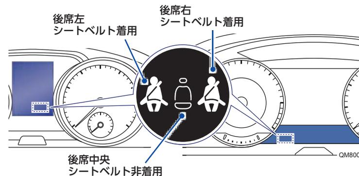
走行中に後席シートベルトが外された場合、この後席シートベルト着用表示が点滅します。車速が 25km/h を超えるとさらに警告音が鳴ります。
