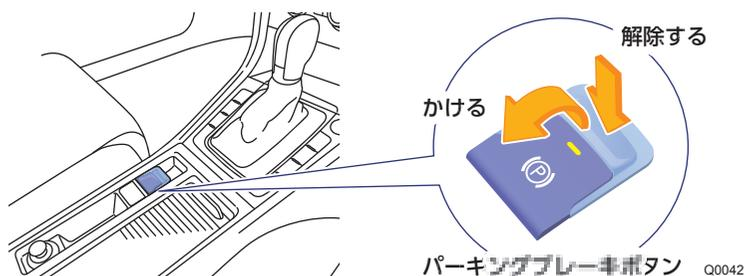
車両が動き出す可能性がある状態で運転席ドアを開けた時など、システムが不適切な駐車状態と判断した場合、パーキングブレーキが自動的に作動します。
