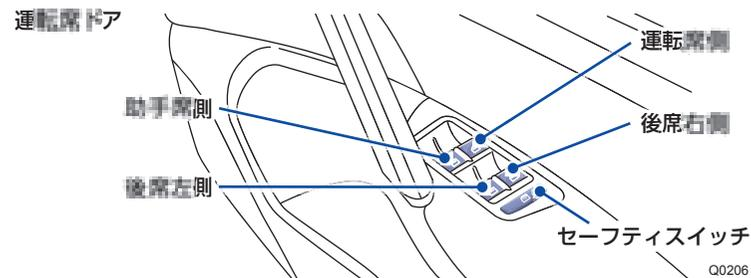
セーフティスイッチを押すと、後席ドアのパワーウィンドーは作動しなくなります。
